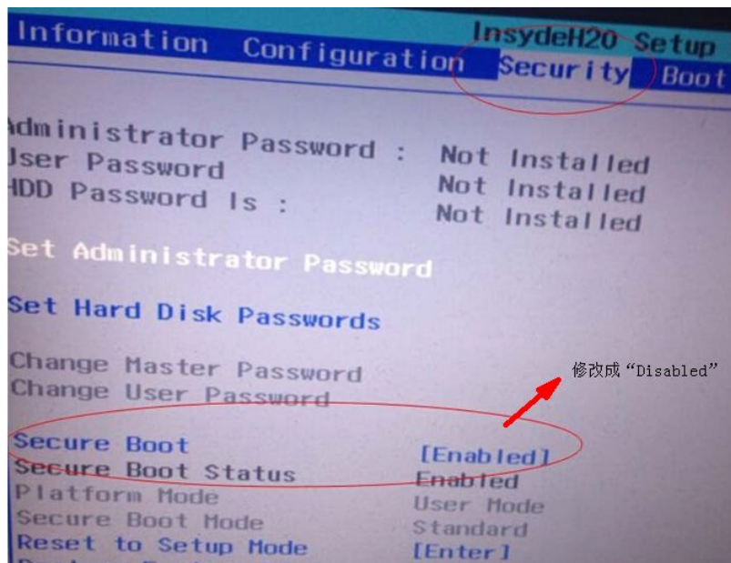
图 2.2 BIOS 关闭 secure boot
